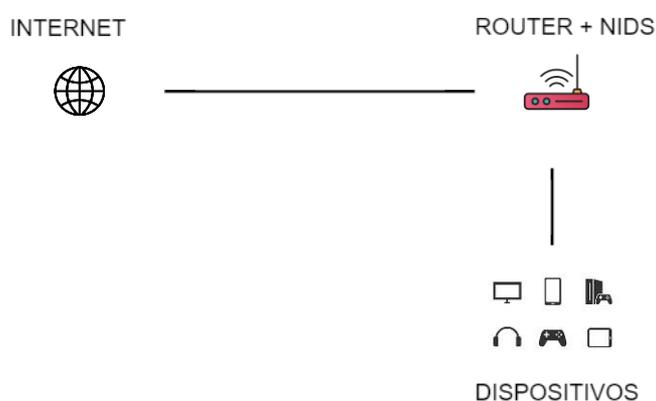
Ilustración 6: Router con servidor NIDS integrado
