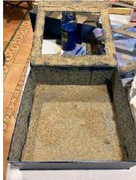
Fig. 21. Secado de la arena.
