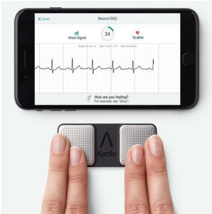
Figura 4.1. Dispositivo Kardia Mobile™ (AliveCor) conectado a la aplicación móvil Kardia App, adquiriendo un ECG equivalente a la derivación I.
