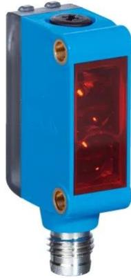
Imagen 24. Fotocélula rectangular Sick, Sistema Reflex, alcance 6 m, salida NPN, Conector M8, IP67
