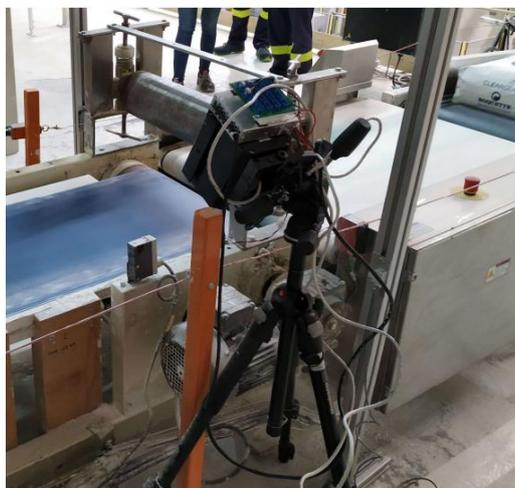
**Imagen 29. Sistema de captura instalado en la línea de producción real.**
