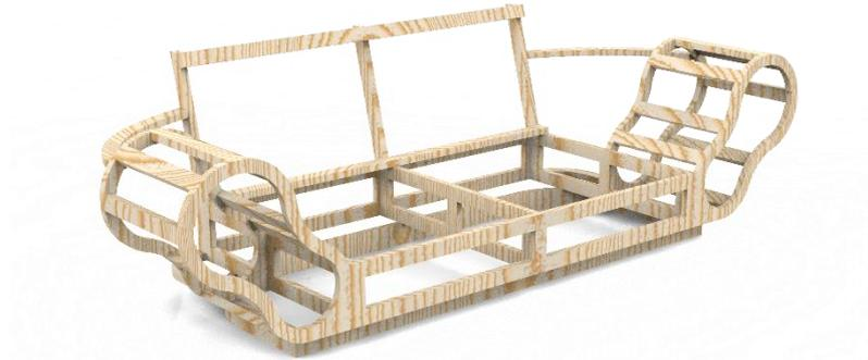
Ilustración 110: Estructura principal del sofá con brazos. Fuente: elaboración propia.
