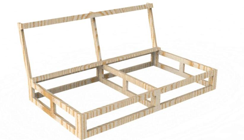
*Ilustración 108: Estructura principal del sofá. Fuente: elaboración propia.*
