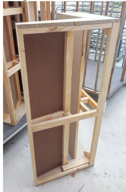
*Ilustración 72: Estructura interior de un sofá. Fuente: elaboración propia en visita a fábrica*
