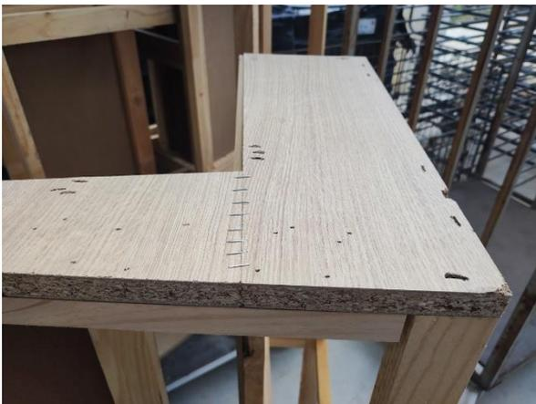
*Ilustración 71: Estructura lateral del sofá de aglomerado de madera. Fuente: elaboración propia en visita a fábrica*
