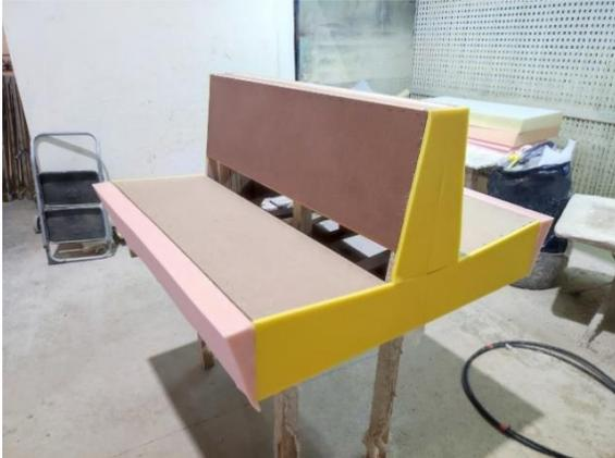
*Ilustración 77: Proceso de colocación de las espumas.
