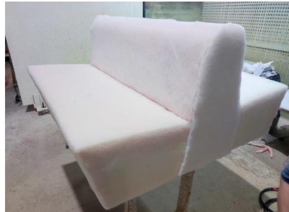
*Ilustración 78: Proceso de colocación de las espumas.
