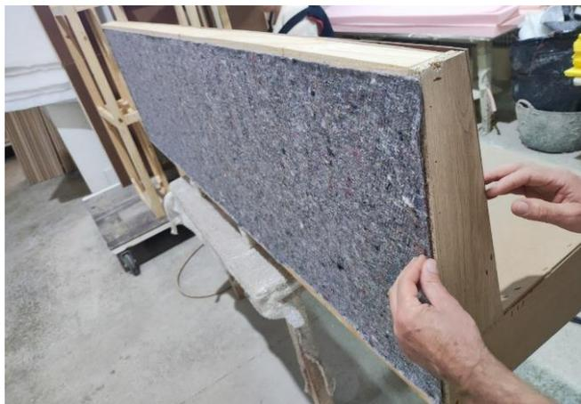
*Ilustración 75: Manta en la parte trasera del sofá. Fuente: elaboración propia en visita a fábrica*
