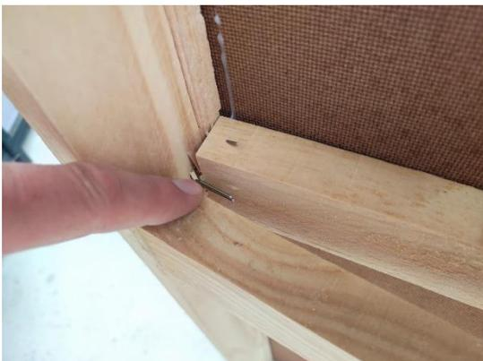
*Ilustración 73: Vista de cerca de una de las grapas especiales utilizadas en el montaje del bastidor de madera. Fuente: elaboración propia en visita a fábrica*
