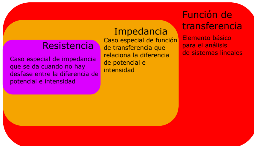
Figura 1.5: Relación conceptual de resistencia, impedancia y función de transferencia
