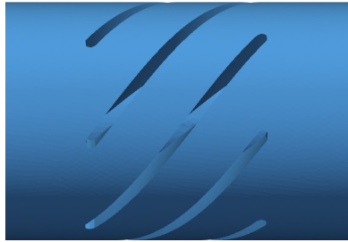
Figura 3.4: Modelo 3D del swirler o torbellinador del flujo que circula a través de los tubos de entrada.
