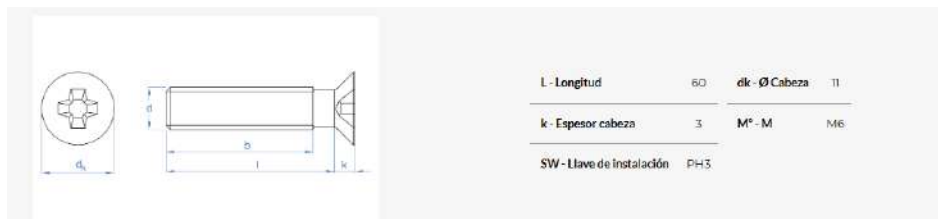
Figura 234. Tornillo rosca métrica avellanada M6 de longitud 60 mm. Fuente: https://www.indexfix.com
