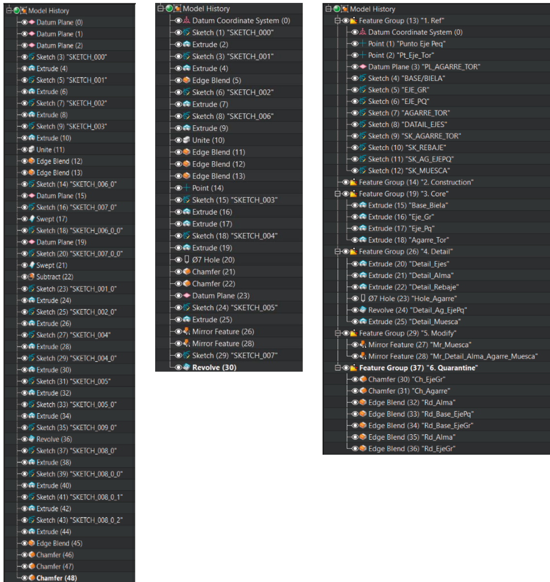
Imagen 7. Comparación árboles de diseño: HM (izq.), ERM (medio) y RM (drcha.)
