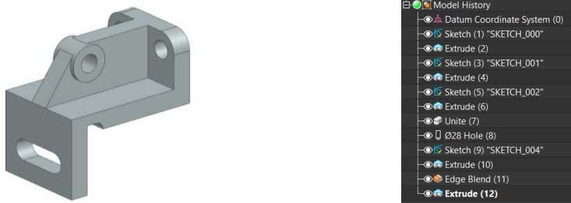
Imagen 2. Pieza ejemplo y su respectivo árbol de diseño
