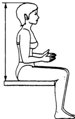
Figura 49. Esquema de la mesura de l'altura assegut (ISO 7250:1996).
