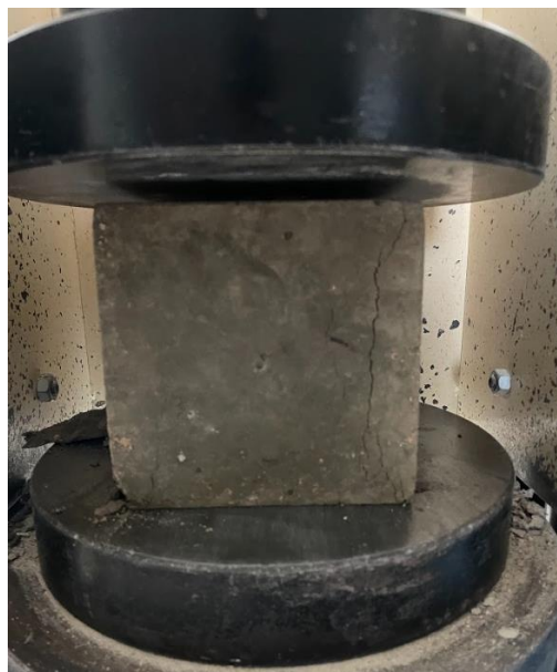
Figura 13: Ensayo de carga sobre probeta cuadrada. (Fuente propia)
