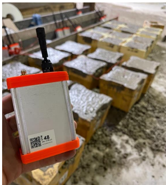
Figura 26: Probetas curadas en condiciones ambientales (Fuente propia).
