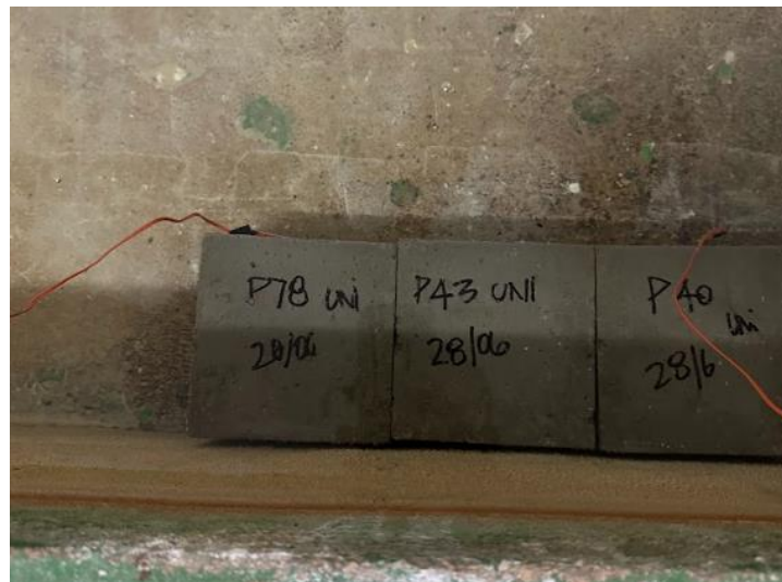
Figura 30: Probetas curadas en condiciones de laboratorio (Fuente propia).
