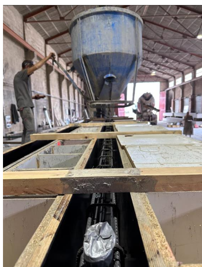
Figura 34: Pieza de hormigón en condiciones de factoría (Fuente propia).
