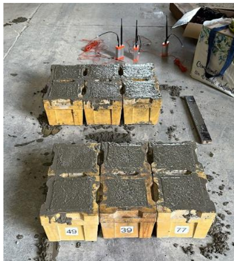
Figura 33: Probetas curadas en condiciones ambientales (Fuente propia).
