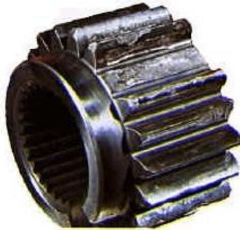
Imagen 7.2: Ejemplo de fallo por flexión de un diente.
