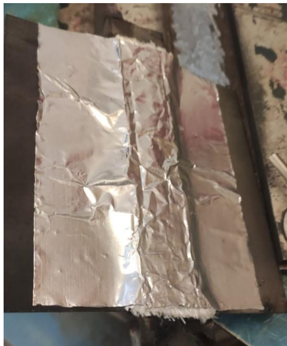
Ilustración 23: Cupón soldado con respaldo cerámico en la parte posterior.
