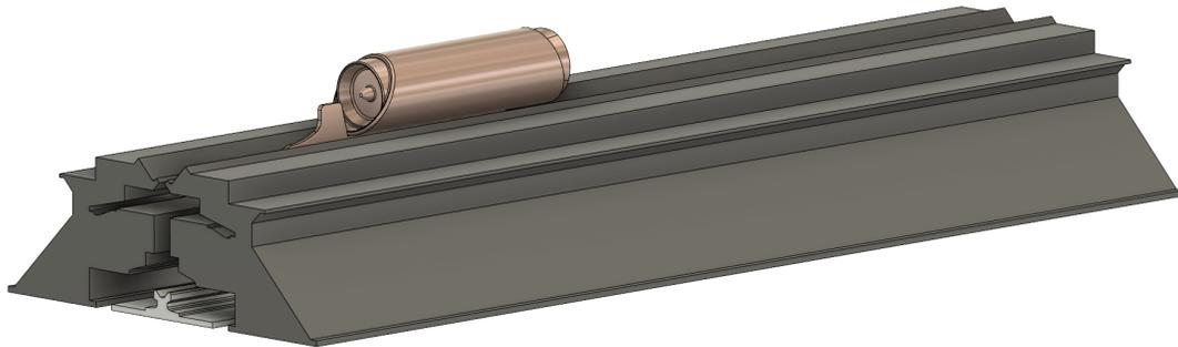
Figura 3.5: Geometría del Caso 1: Estructura soporte extruida
