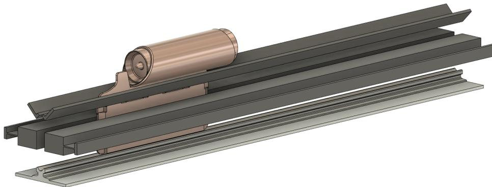
Figura 3.6: Geometría del Caso 2: Estructura soporte tangente
