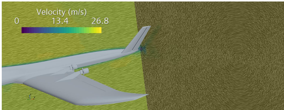
Figura 3-10 – Campo vectorial de velocidades en la estela de la aeronave sin tren de aterrizaje volando a V=24\text{m/s} y \alpha=0^\circ .
