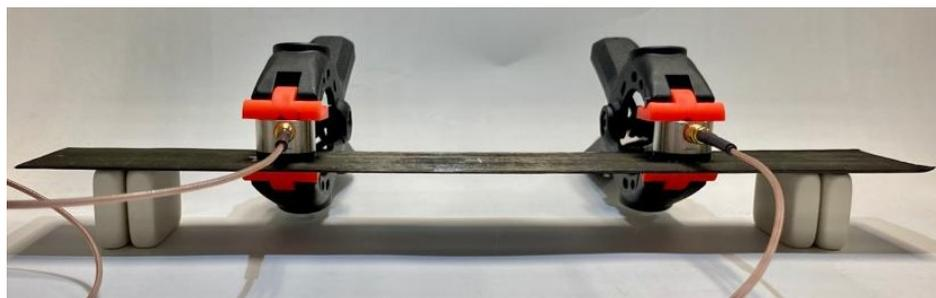
Figura 3.3: Sujeción de los sensores a la placa de CFRP.
