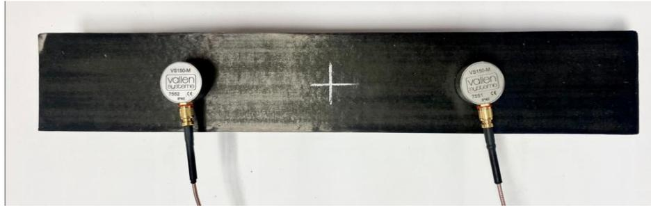
Figura 3.2: Ubicación de los sensores sobre la placa de CFRP.
