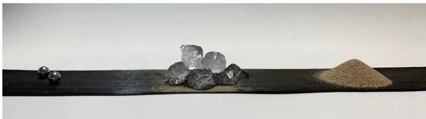
Figura 3.1: Objetos utilizados para ejercer los impactos (esfera, hielo y arena) sobre la placa unidireccional de CFRP en la que se realizan los ensayos.
