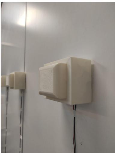
*Figura 42. Vista lateral de los botones ya colocados y cableados en la instalación final.*
