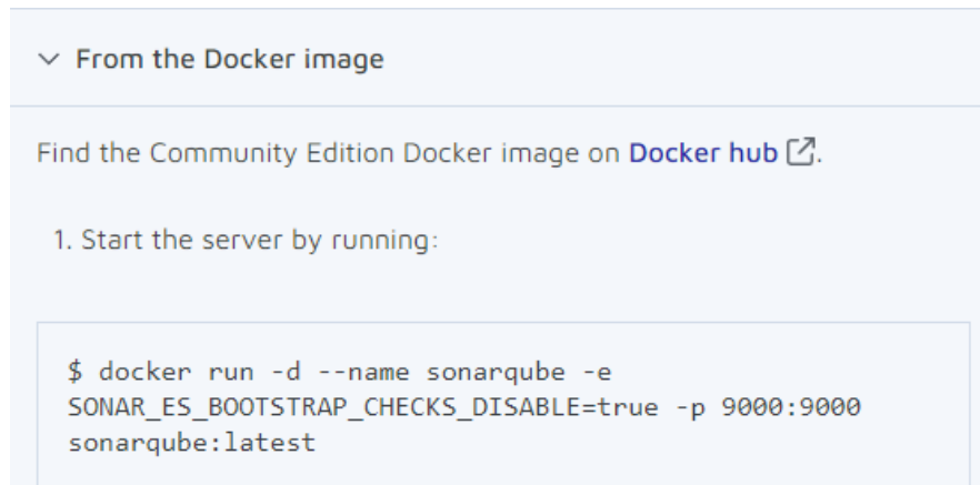
Ilustración 4 - Instalación de una instancia SonarQube desde un contenedor Docker [13]
