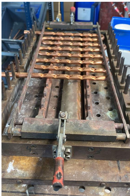
Figura 18: util soldar evaporadores
