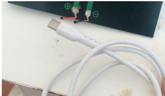
Figura 23: cargador móvil alimentado por el panel instalado al seguidor solar.
