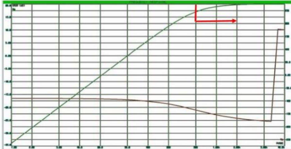
Figura 37: Diagrama de Bode de un pseudointegrador. [13]
