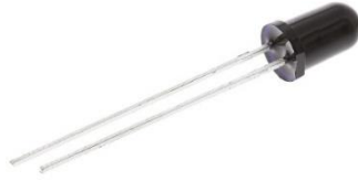
Figura 9: fotodiodo empleado (SFH 203FA).
