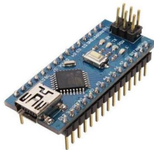
Figura 11: Microcontrolador tipo Arduino nano. [7]
