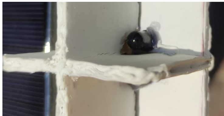
Figura 56: Imagen de uno de los fotodiodos colocado ligeramente separado del muro.
