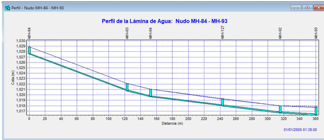
Figura 32. Perfil longitudinal de los conductos C102 a C8 después de las actuaciones.
