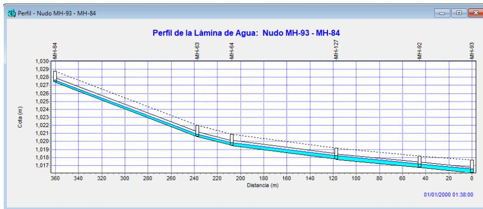
Figura 33. Perfil longitudinal de los conductos C104 a C46 con actuaciones.
