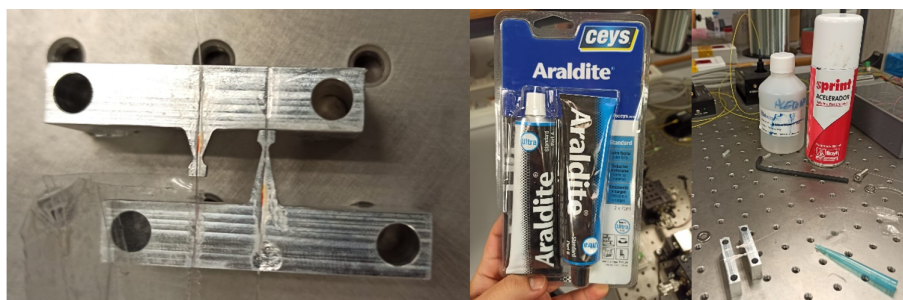
Figura 12: Inscripción de fibras en piezas mecánicas, y elementos utilizados para su adhesión.
