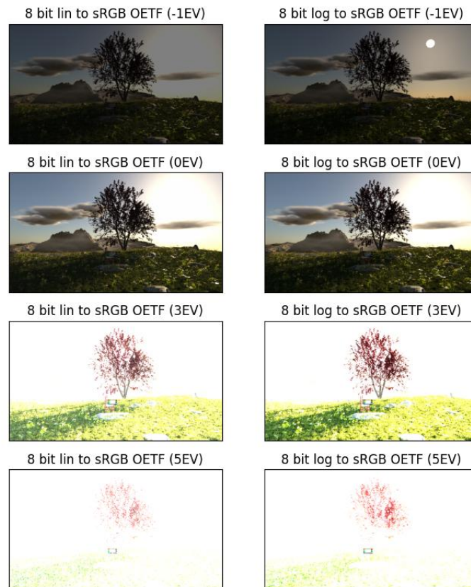
Figura 1.48: Diferencia al modificar la exposición de una imagen lineal y otra con codificación logarítmica
