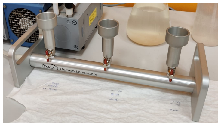
Figura 3.13: Rampa de filtrado
