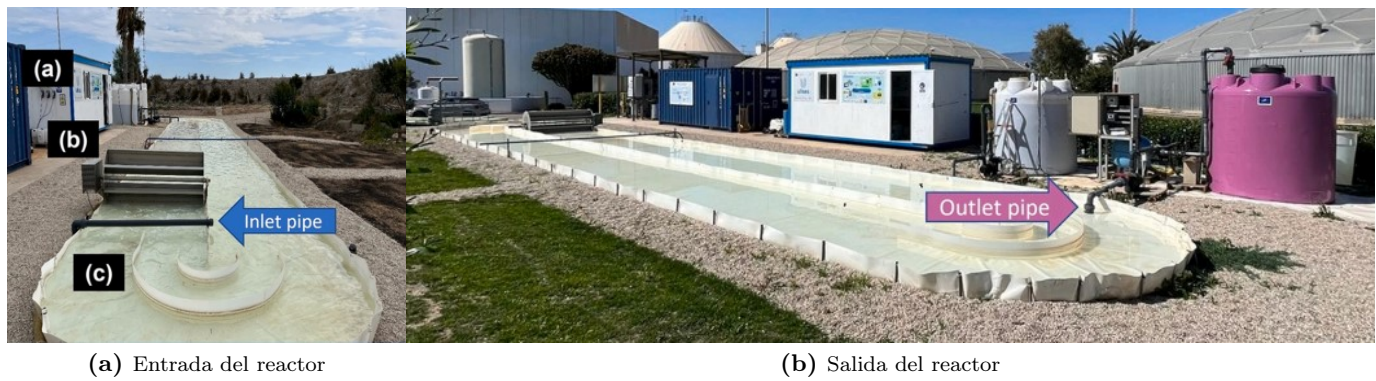
Figura 6.2: Montaje del escalado. (a) Bombas de dosificación,(b) Molino de agitación,(c) Balsa reactor Raceway (Gualda-Alonso et al., 2022)
