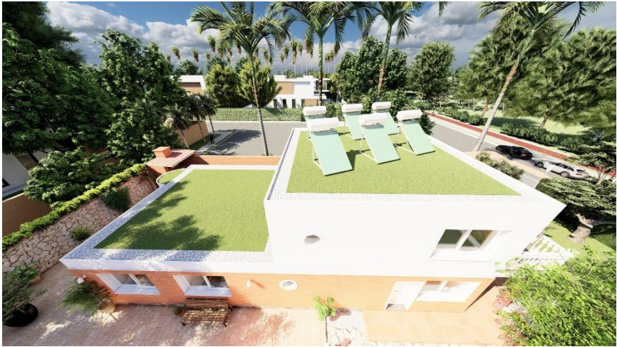
Ilustración 81. Cubierta plana ajardinada. Fuente propia
