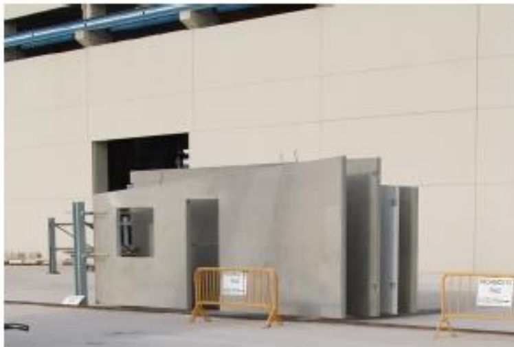
Ilustración 70. Acopio de paneles. www.prefabricadoscanal.com
