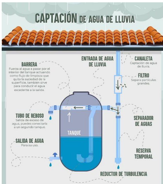
Ilustración 16. Tanque de aguas pluviales. www.pinterest.com
