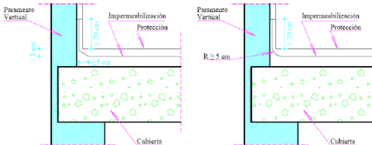
Imagen 17: Encuentro de la cubierta con paramento vertical. Fuente CTE
