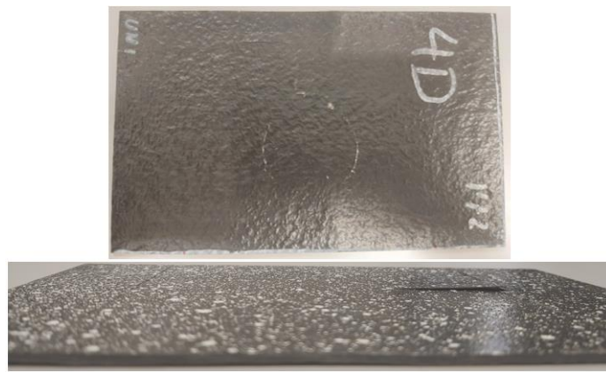
Figura 48: Delaminación y rotura de fibras producida por percutor plano con 30.14 Julios en placa de CFRP unidireccional.
