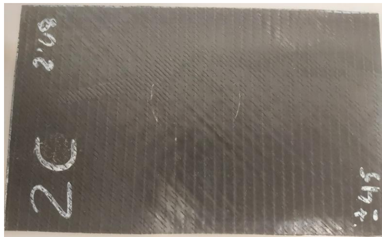
Figura 54: Rotura de fibras producida en la superficie impactada de la muestra.
