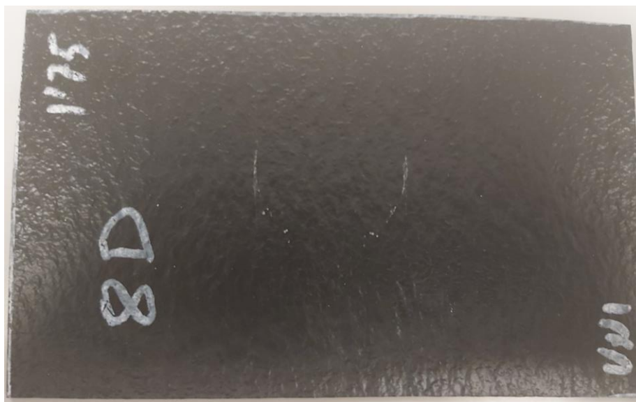
Figura 44: Daño generado por el percutor plano en la superficie de impacto de la muestra ensayada.
