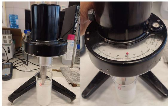
**Figura 6.** Viscosímetro rotacional analógico Brookfield.
