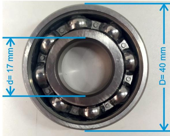
Figura 50. Rodamiento metálico modelo 6203 2RS, utilizado durante la experimentación.
