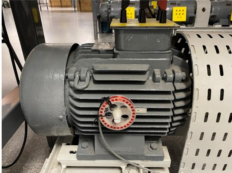
Figura 62. Segundo motor probado durante los experimentos (motor 2): 7,5 kW, 2 pares de polos
