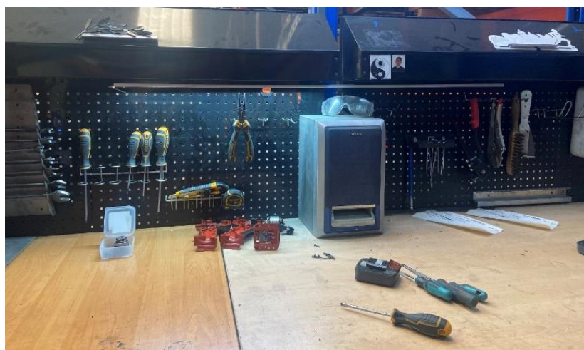
Ilustración 31: Implantación de metodología 5S en la sección de mecanizado. Fuente: Instalaciones de la compañía.
