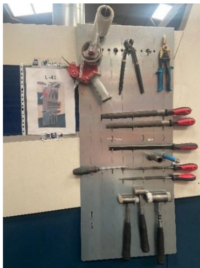
Ilustración 30: Implantación de metodología 5S en la sección de corte láser. Fuente: Instalaciones de la compañía.
