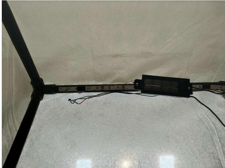
Figura 59. Tira de LEDs, calentador y sensor de temperatura instalados dentro del invernadero
