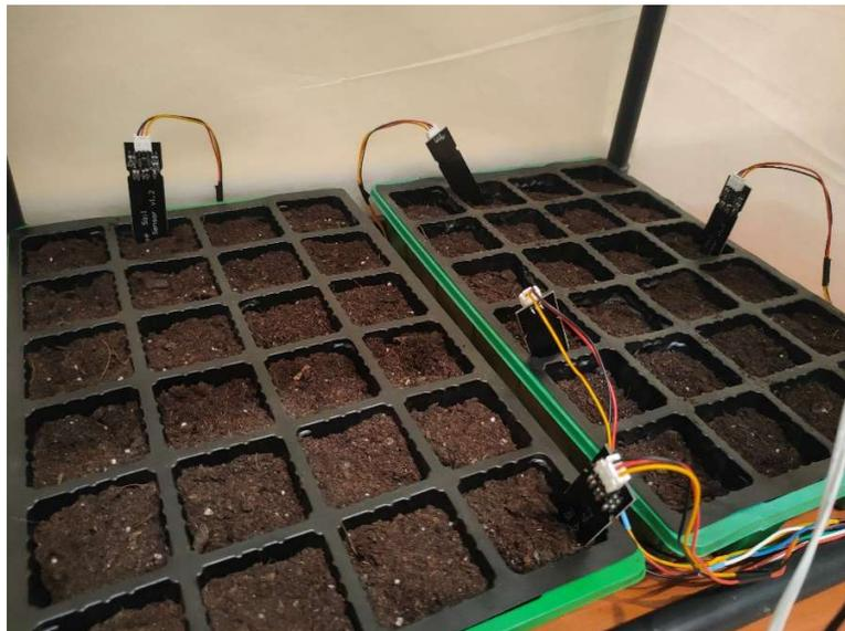
Figura 60. Sensores de temperatura instalados dentro de los semilleros
