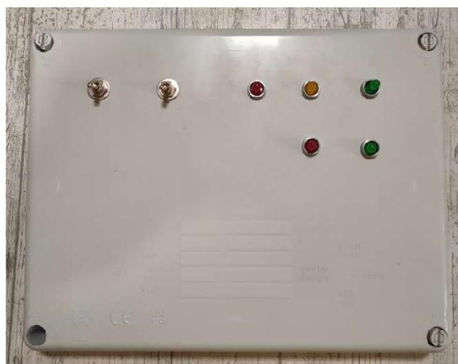
Figura 56. Tapa de la caja eléctrica con interruptores y LEDs
