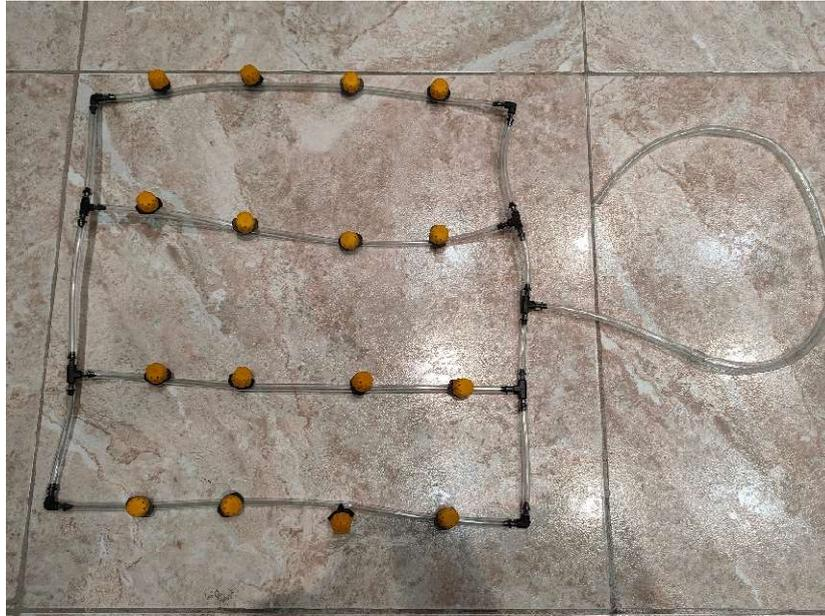
Figura 57. Sistema de riego montado fuera del miniinvernadero
