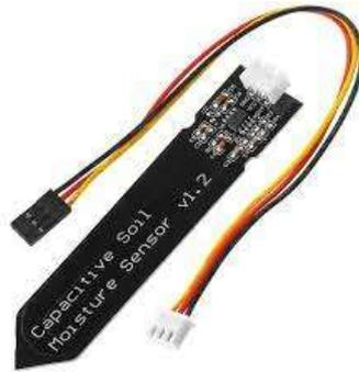
Figura 9. Sensor de humedad capacitivo
