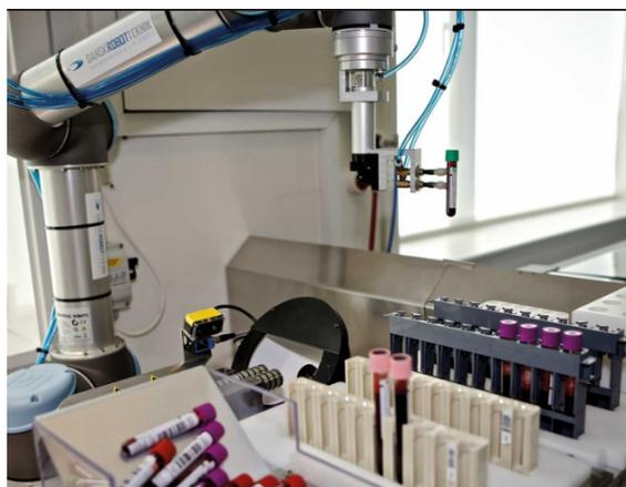
Figura 3: Brazo robótico para manipulación de muestras biológicas
