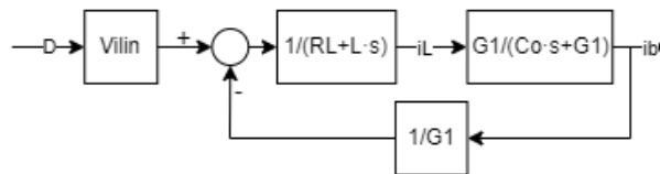
Figura 38. Esquema realizado con draw.io Ecuaciones de estados en forma de diagramas de bloques. Paso 4 de simplificación
