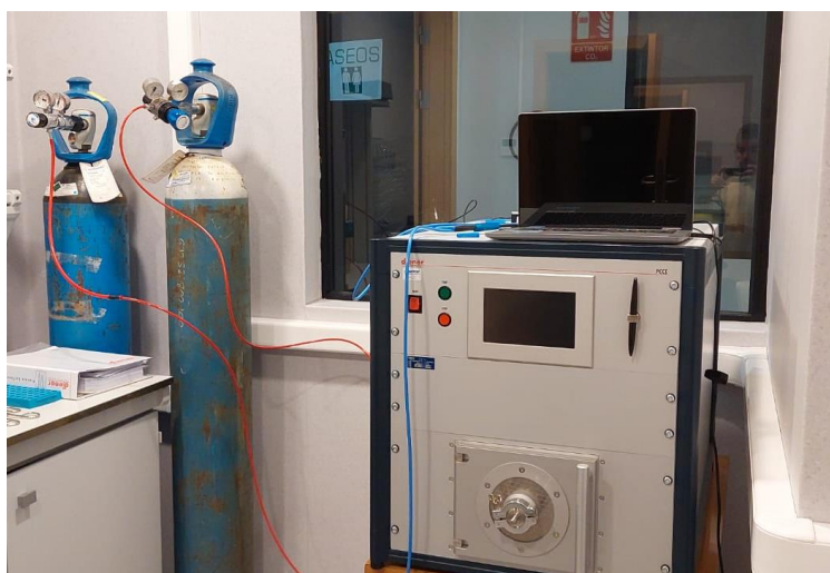
Figura 3. Equipo de plasma a baja presión junto a las balas de gas de oxígeno y nitrógeno.
