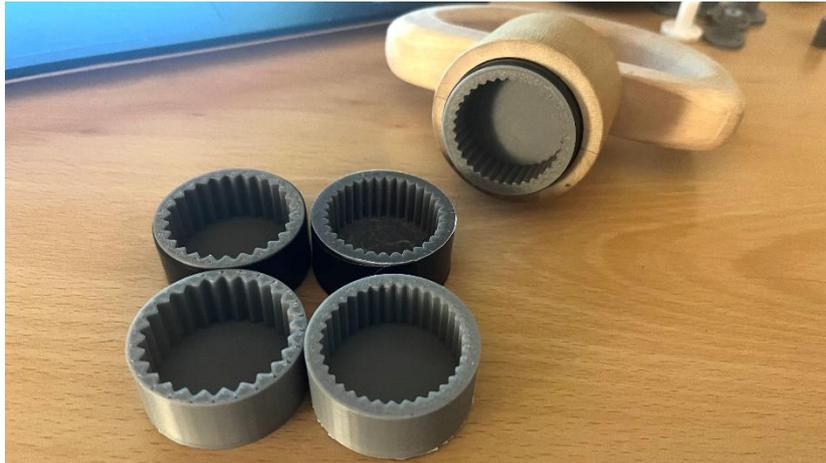
Figura 186. Pruebas de impresión 3D del agarre para los tapones.
