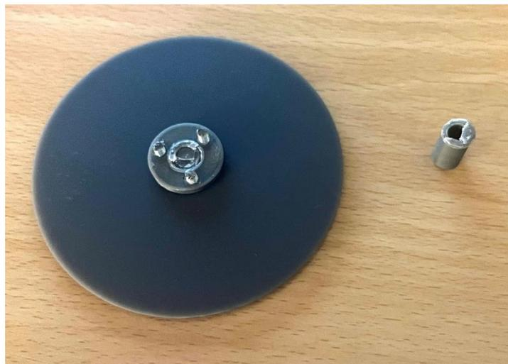
Figura 187. Rotura de la pieza que engancha el eje del motor con el plato giratorio.
