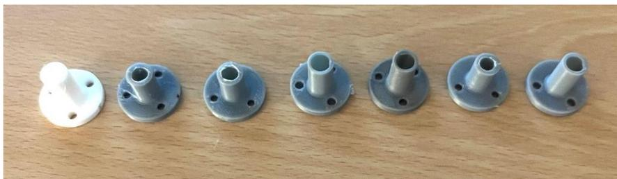
Figura 185. Pruebas de impresión 3D de la pieza que engancha el eje del motor con el plato giratorio.
