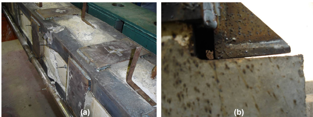
Fig. 3.44. Instante de la rotura de las probetas PBD y PBC. (a) Rotura del hormigón situado en la zona central de la probeta, y plastificación de los angulares; (b) Deformación experimentada por los capiteles
