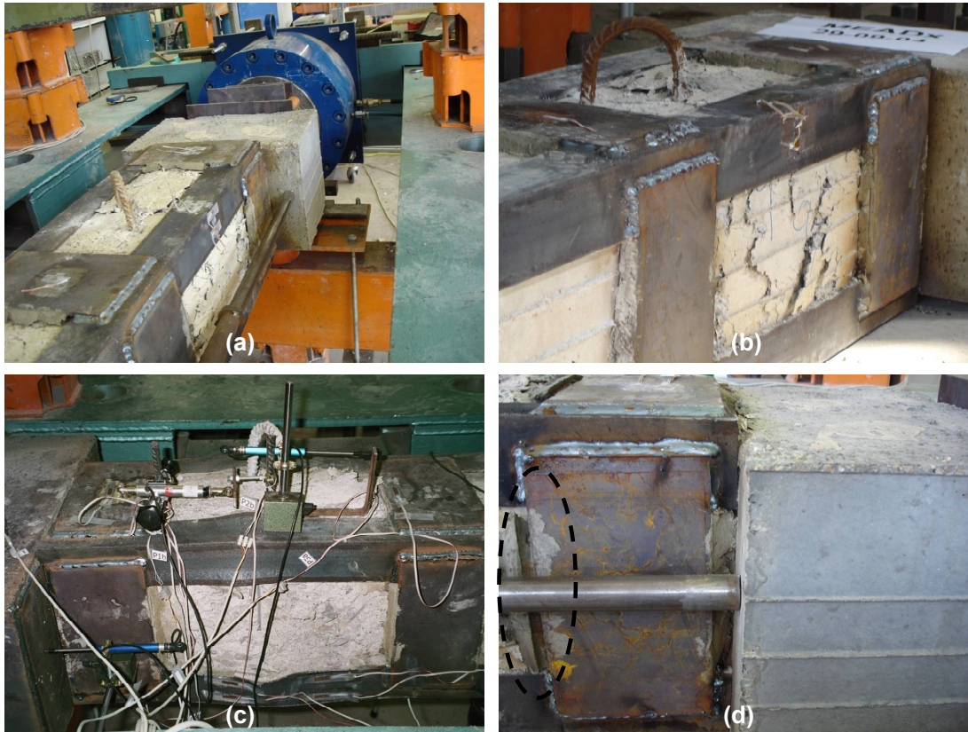
Fig. 3.38. Instante de la rotura de las probetas ADB y AC. (a), (b) Rotura del hormigón situado entre las 2 primeras presillas; (c) Rotura del hormigón situado entre las 2 primeras presillas y plastificación de los angulares del refuerzo; (d) Deslizamiento relativo entre los elementos del refuerzo y el mortero de la interfaz
