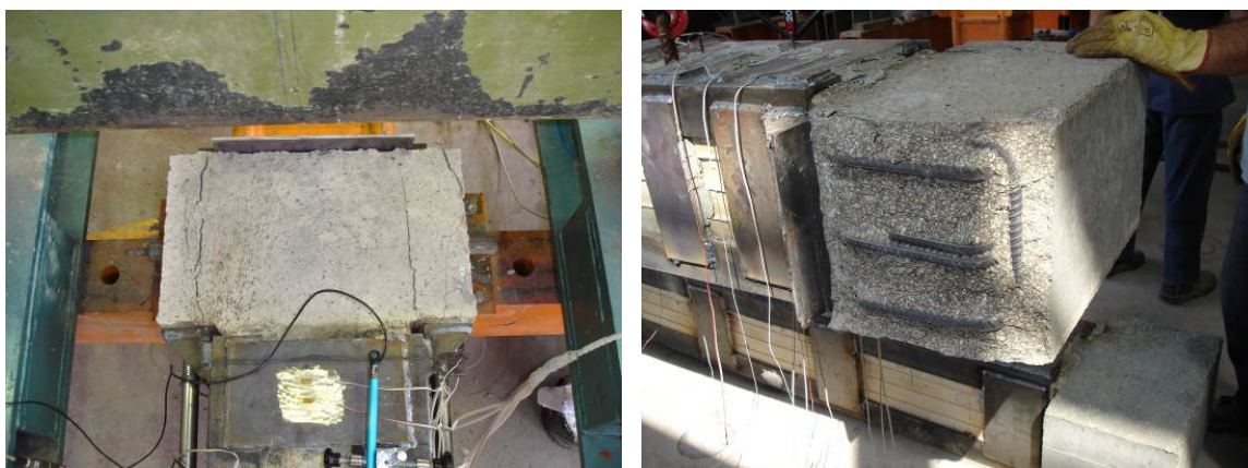
Fig. 3.9. Rotura de las cabezas de HA en las probetas en las cuales se disponen capiteles en los extremos del refuerzo
