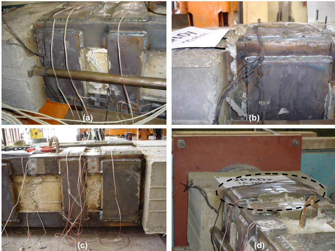
Fig. 3.42. Instante de la rotura de las probetas PAD y PAC. (a), (b), (c) Rotura del hormigón situado en los extremos de la probeta; (d) Deformación de la primera presilla en la dirección perpendicular a la misma
