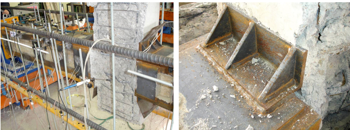
Fig. 5.19. Modo de rotura de la probeta AxL.C
