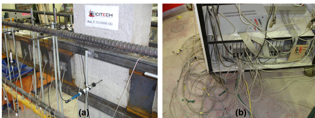
Fig. V.17. (a) LVDT empleado para controlar posible problemas de pandeo de las probetas; (b) Conexión en el equipo de adquisición de datos de los elementos empleados para la monitorización de las probetas
