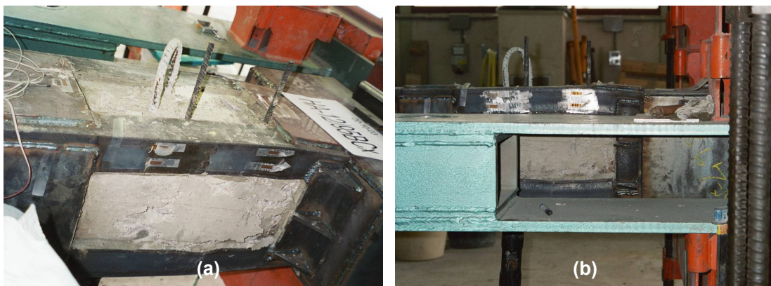
Fig. 3.40. Instante de la rotura de las probetas BD y BC. (a) Rotura del hormigón situado entre las 2 primeras presillas; (b) Plastificación y deformada de los angulares situados en los extremos de las probetas
