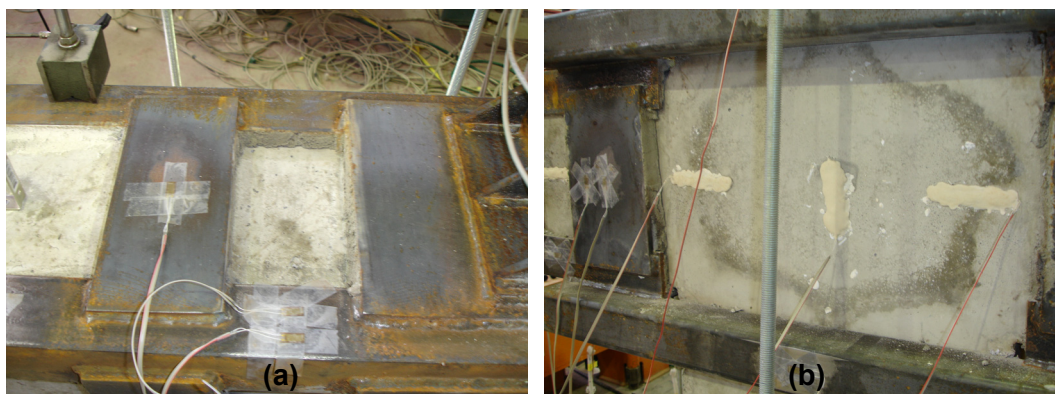
Fig. V.15. Galgas extensométricas. (a) Sobre una superficie de acero; (b) Sobre una superficie de hormigón
