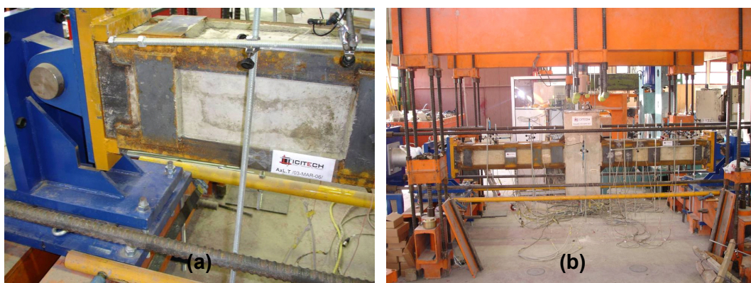
Fig. V.13. Posición final de la probeta dentro del pórtico de ensayos. (a) Extremos de la probeta; (b) Vista general de la probeta dispuesta para ser ensayada
