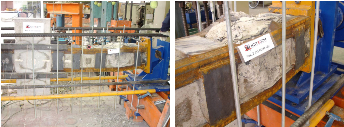
Fig. 5.20. Modo de rotura de la probeta AxL.T
