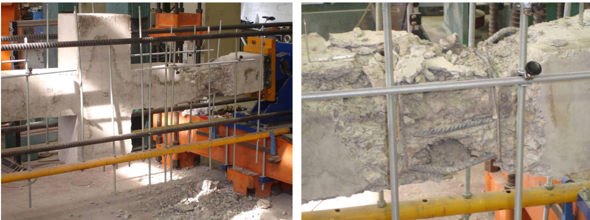
Fig. 5.18. Modo de rotura de la probeta T1
