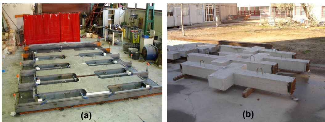
Fig. V.4. (a) Probetas recién hormigonadas; (b) Zona de acopio de las probetas
