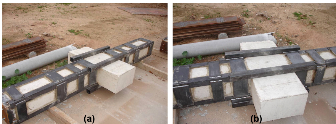
Fig. 5.10. Probeta AxL.T. (a) Vista general; (b) Detalle del nudo viga-soporte
