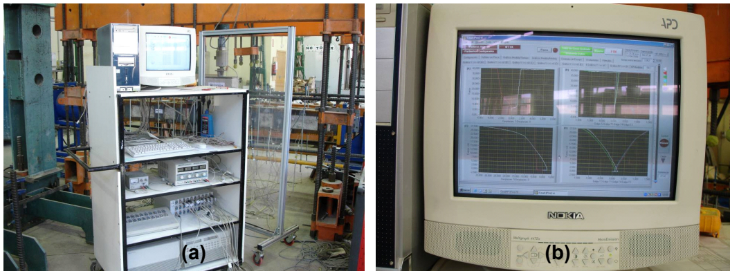
Fig. V.18. (a) Equipo de adquisición de datos. (b) Pantalla con medidas en tiempo real
