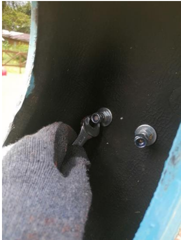
Ilustración 92: Unión primera fila de ruedas a estructura. Fuente: Propia.
