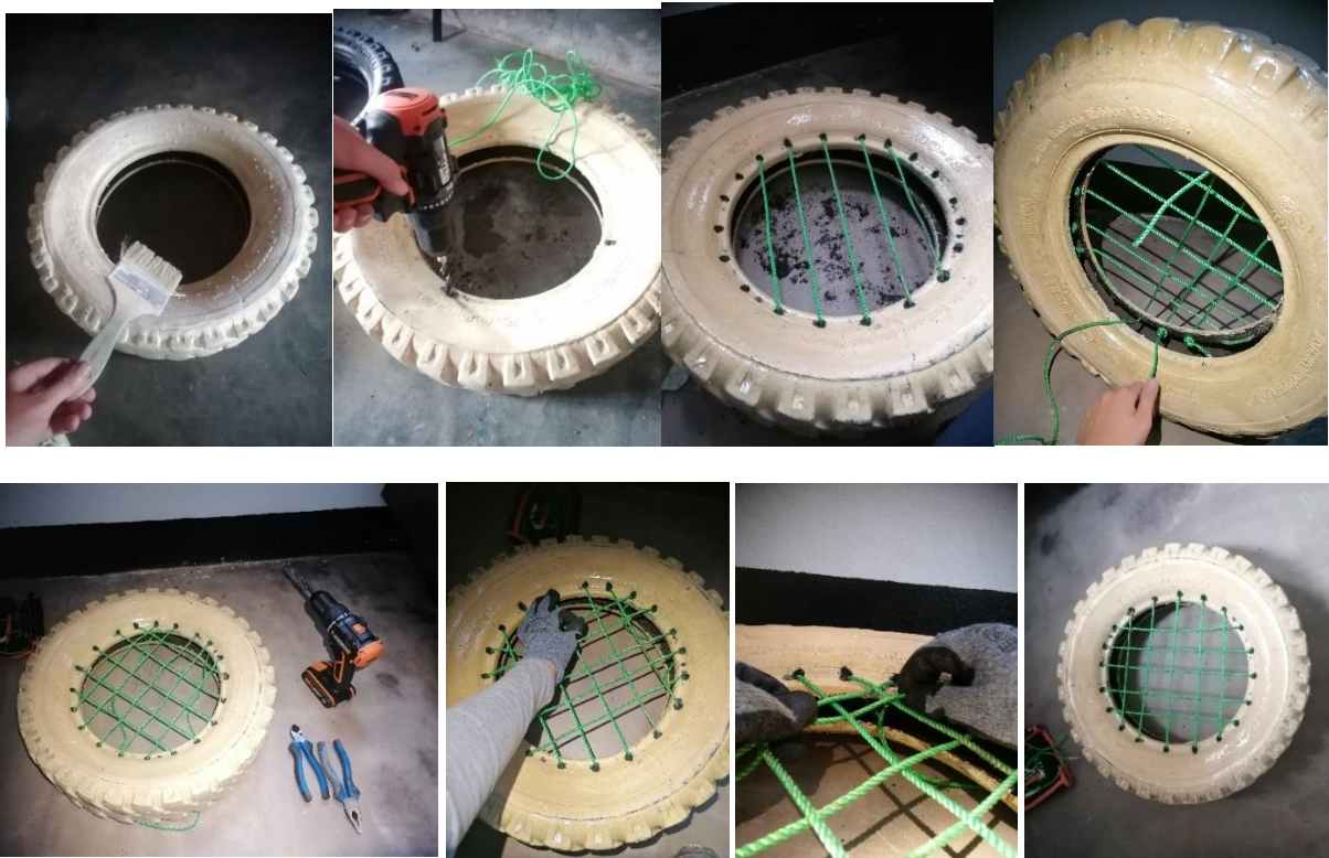
Ilustración 121: Realización asiento columpio. Fuente: Propia.
