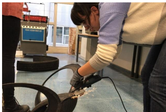
Ilustración 15: Prueba de corte de neumático con radial. Fuente: Propia
