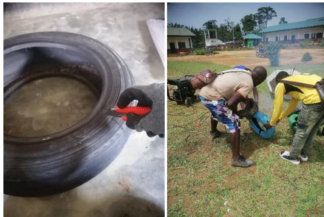
Ilustración 71: Marcado y corte ruedas. Fuente: Propia.
