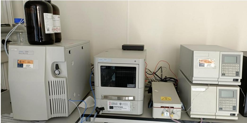
*Figura 15. Equipo de cromatografía de permeación en gel.*
