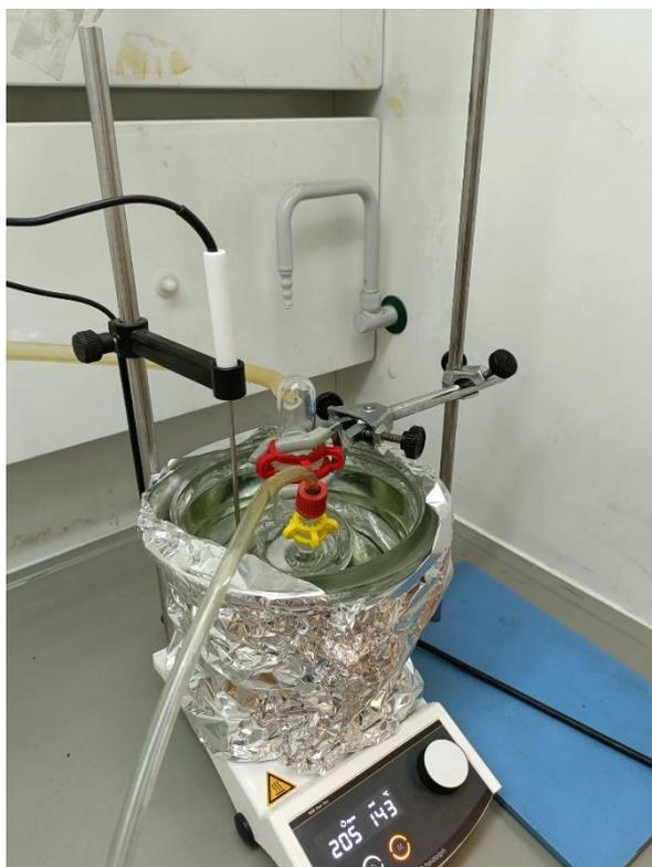
*Figura 10. Montaje para la síntesis del prepolimero de PGS.*
