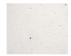
(d) sample 8 Ti64 + N2 magnification x10 before etching
