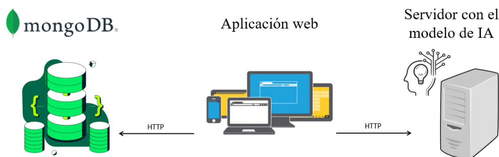
Figura 5.1: Estructura general de comunicaciones
