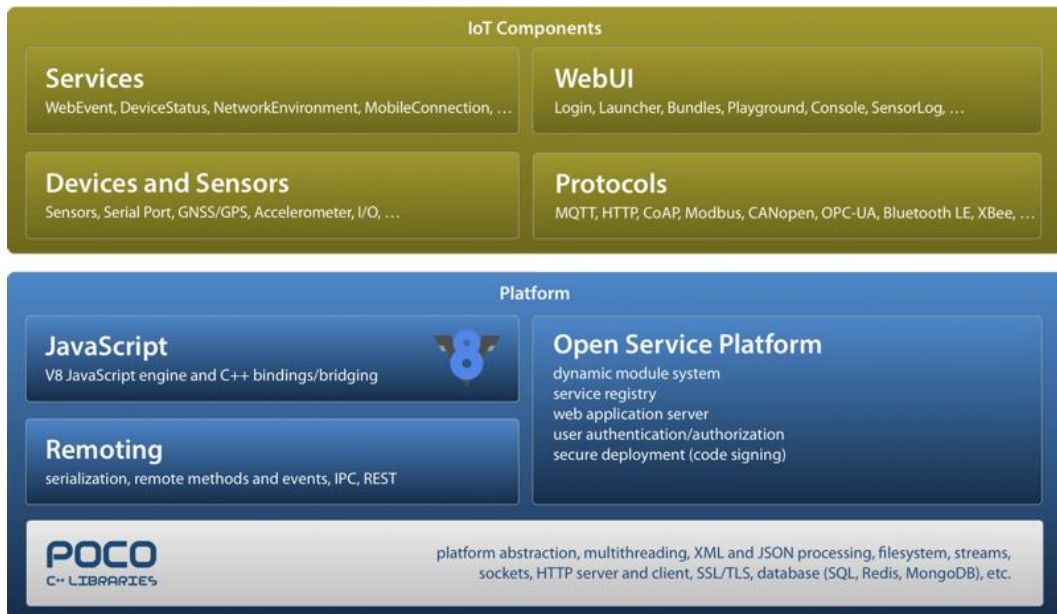
Ilustración 22. Arquitectura de Machine.IO EDGE
