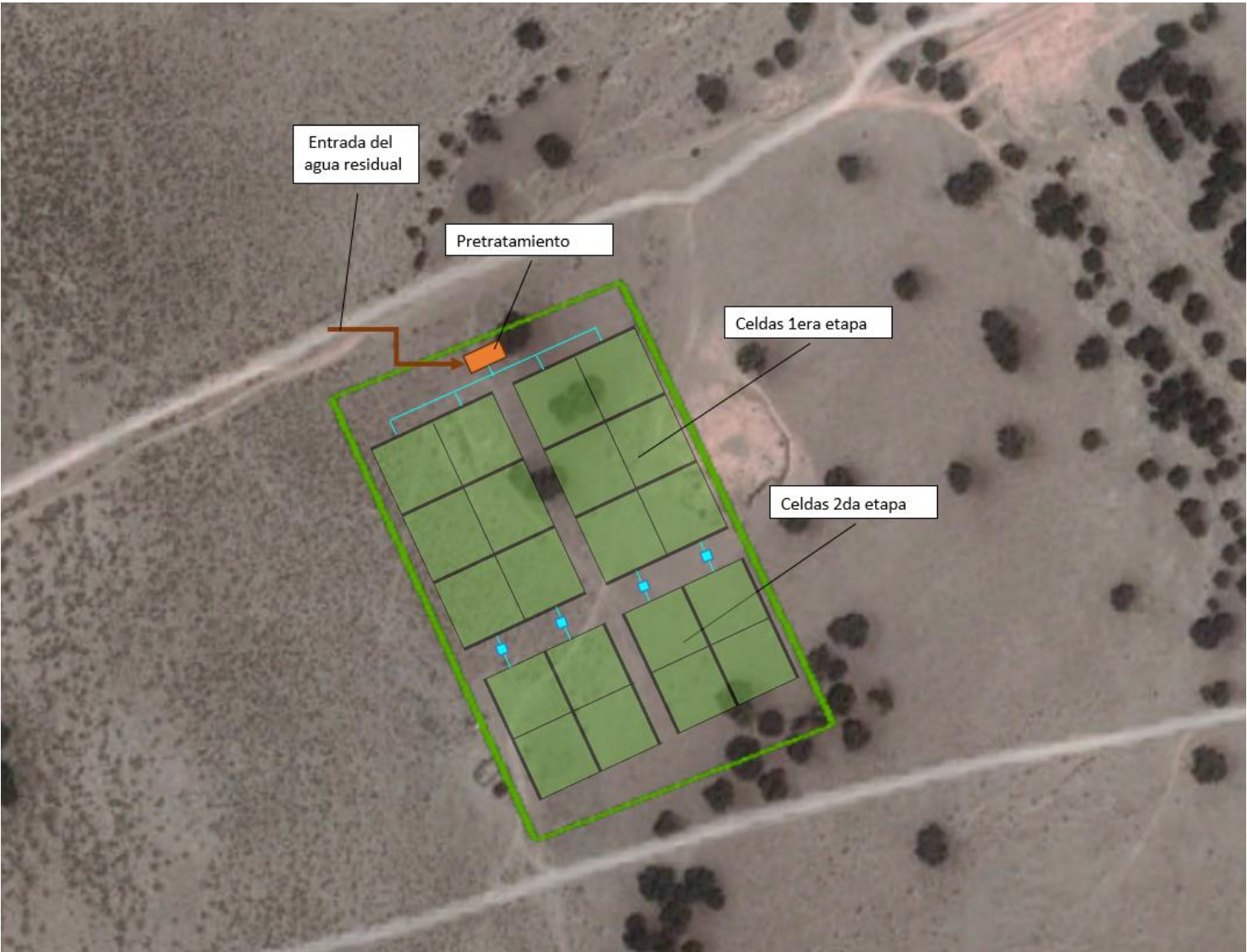
Anexo 6: Esquema del emplazamiento y partes del proceso de depuración con HAFSsV.
