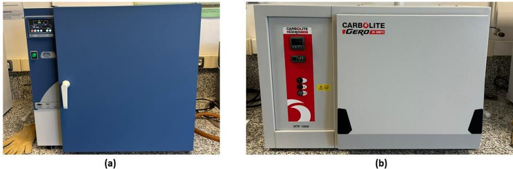
**Figura 10** a) Estufa usada para las etapas de gelificación, envejecimiento y secado. b) Horno convencional usado para la etapa de estabilización
