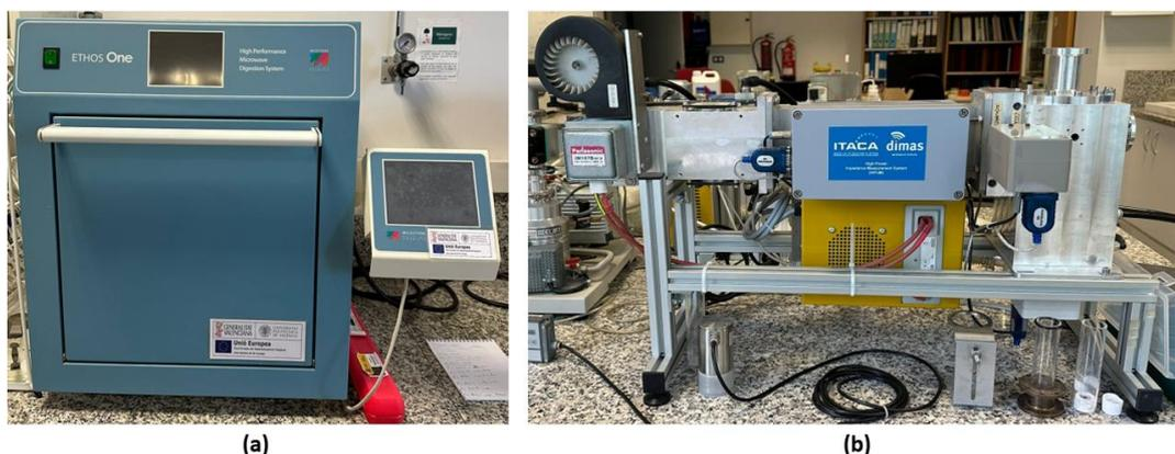
Figura 11 a) Horno microondas b) Microondas de elaboración propia usado para la etapa de estabilización
