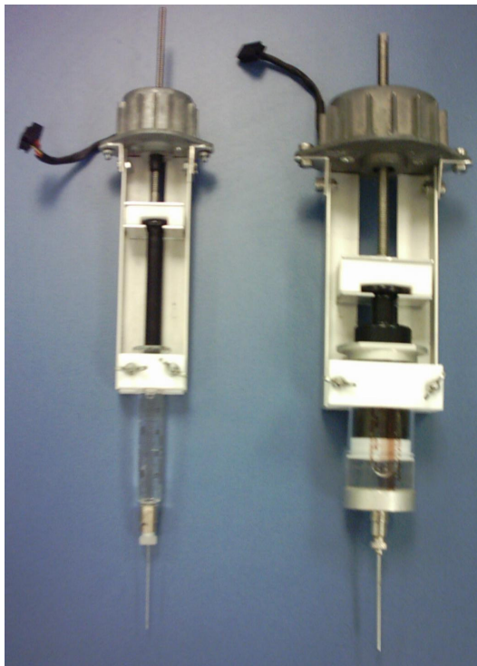
Figura 3.10. A) Fotografía de los dos tipos de perfusoras, tanto para jeringas de 5 ml., como para jeringas de 50 ml. B) Esquema de la perfusora, indicando los materiales que la conforman.
