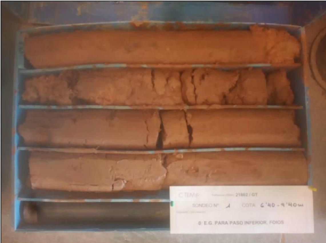
Figura 8. Caja Portatestigos Sondeo N<sup>o</sup>1 entre cotas 6,40 – 9,40 m. Fuente: CYTEM
