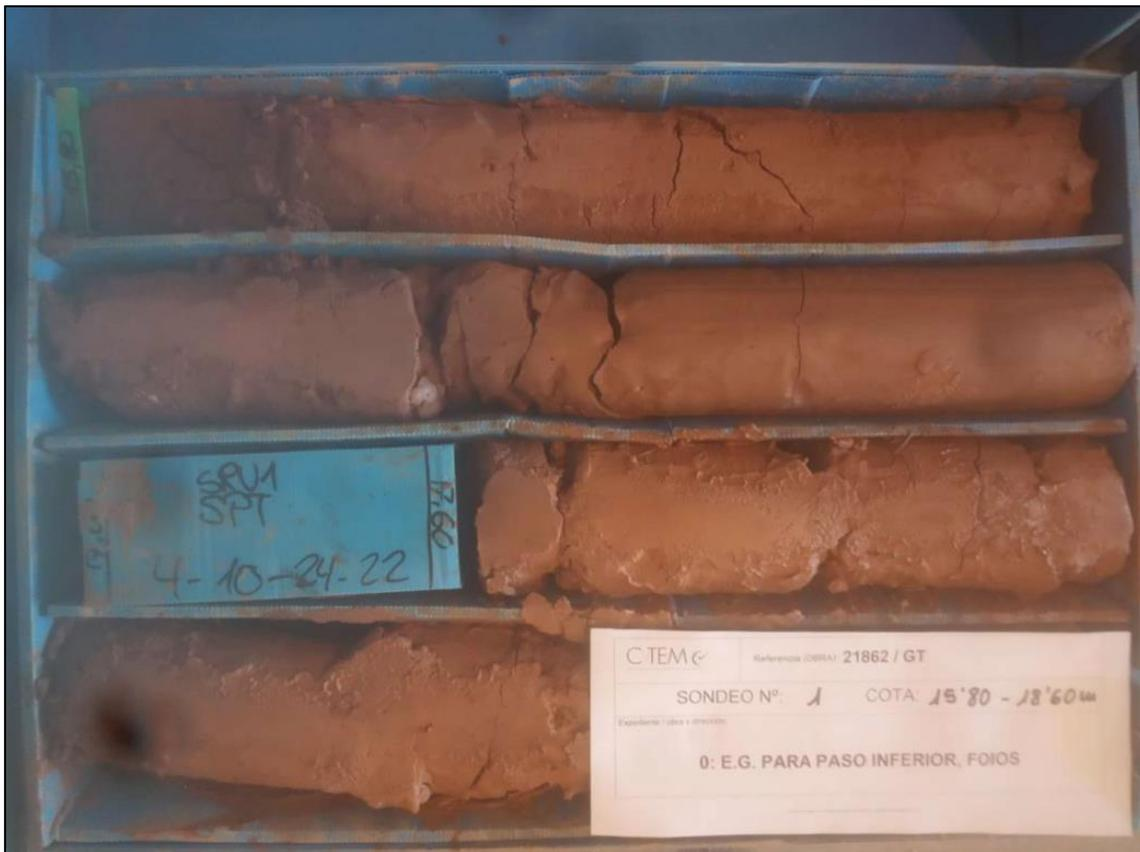
Figura 9. Caja Portatestigos Sondeo Nº1 entre cotas 15,80 – 18,60 m. Fuente: CYTEM
