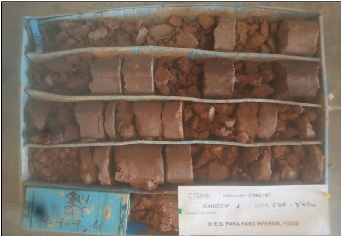
Figura 6. Caja Portatestigos Sondaje Nº1 entre cotas 0,00 – 3,40 m. Fuente: CYTEM
