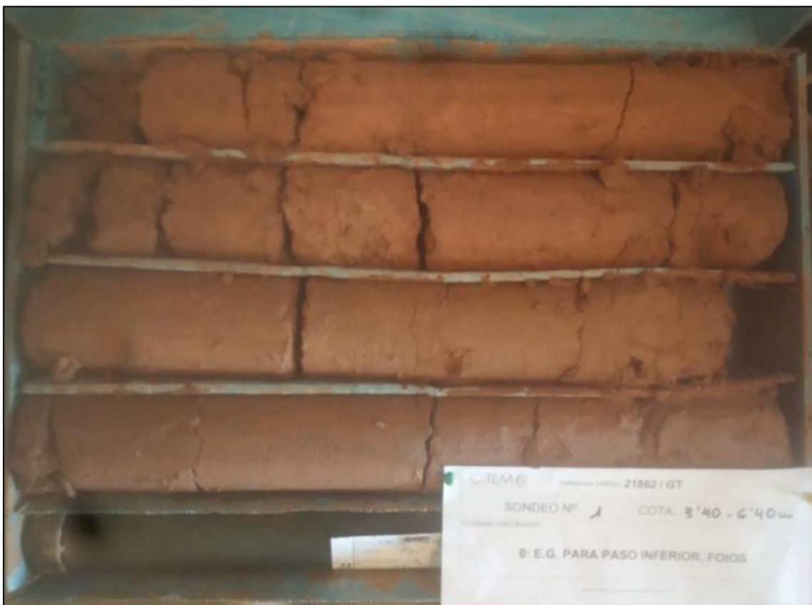
Figura 7. Caja Portatestigos Sondaje Nº1 entre cotas 3,40 – 6,40 m. Fuente: CYTEM
