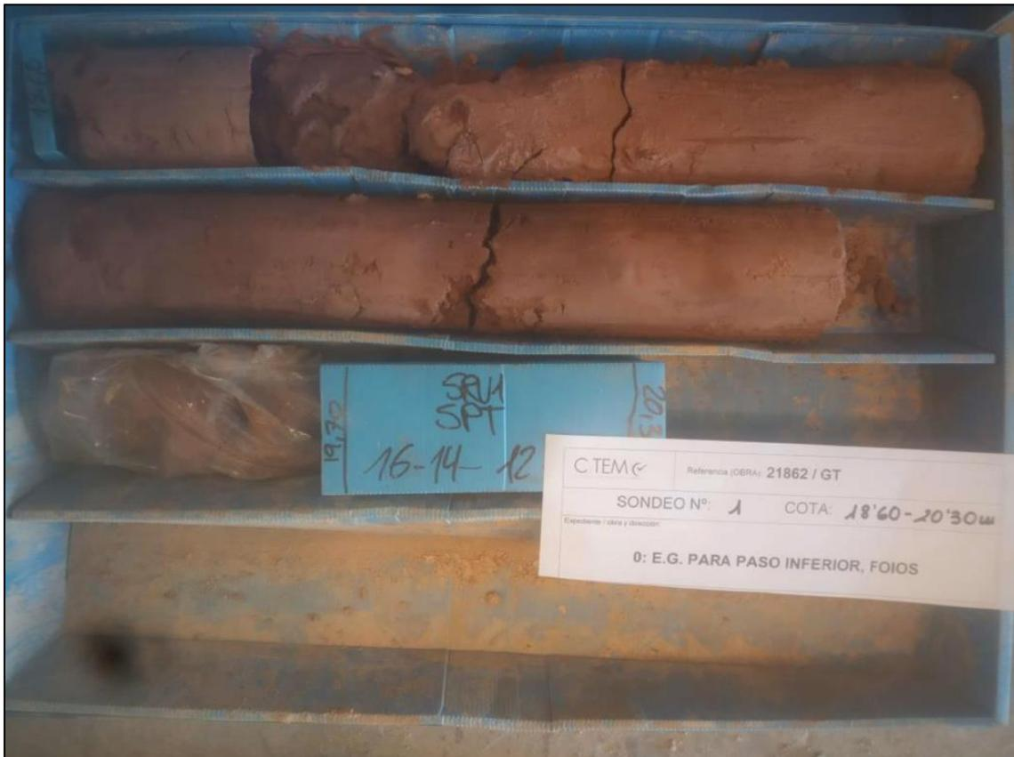
Figura 10. Caja Portatestigos Sondeo Nº1 entre cotas 18,60 – 20,30 m. Fuente: CYTEM
