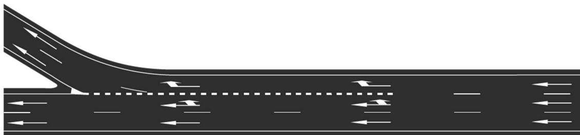
Fig. I-8. Carril bífido directo. Nótese que, pese a comenzar con tres carriles básicos, la conversión del carril derecho reduce su número a dos, número que se mantiene constante durante la bifurcación. Si el carril derecho fuera básico en todo su recorrido, sí se trataría de un carril bífido indirecto. Elaboración propia
