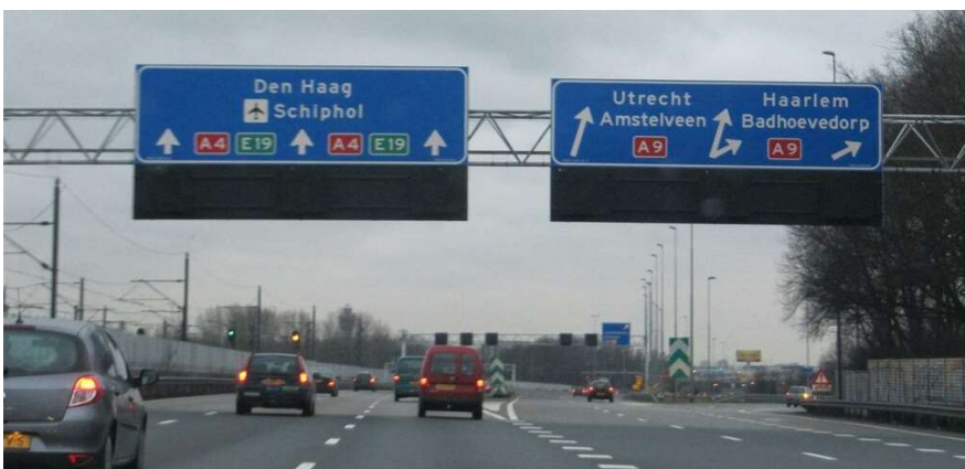
Fig. II-33. Pórtico de la A4 sentido sur en el nudo Badhoevedorp con la A9. Nótese cómo aquí se refleja mediante la inclinación de las flechas del cartel derecho un carril bífido en el ramal de salida , y el uso de flechas cortas en el cartel izquierdo por ser un cartel de señalización inmediata. Mavas, Wegenforum.nl
