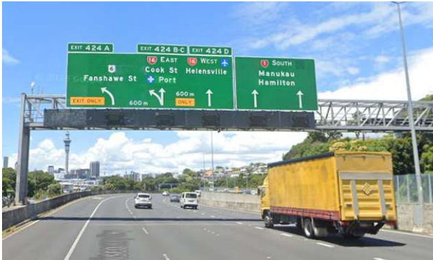
Fig. II-62. Carteles flecha por carril neozelandeses. Nótese que los tres carriles de la izquierda son salidas sucesivas. State Highway 1, sentido sur, salidas 424 A, B-C y D. Google Street View
