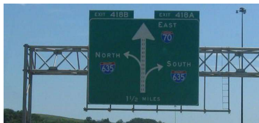
Fig. III-10. A la izquierda, cartel diagramático indicando una divergencia múltiple; ejemplo ofrecido en el Manual of Uniform Traffic Control Devices for Canada . A la derecha, cartel diagramático preseñalizando dos salidas sucesivas; I-70 sentido este, salidas 418B y A, Texas, Estados Unidos. Transportation Association of Canada; Google Street View .
