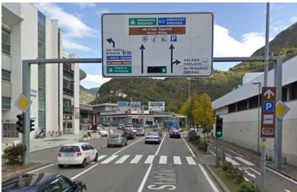
Fig. II-24. Una Segnale di preselezione señalizando en Bolzano, aunque prescindiendo de la línea intermitente mostrada en normativa. Este cartel se encuentra actualmente sustituido por una versión flecha abajo que no indica el desvío a la derecha. Salida 12 de la SS12, sentido norte. Google Street View
