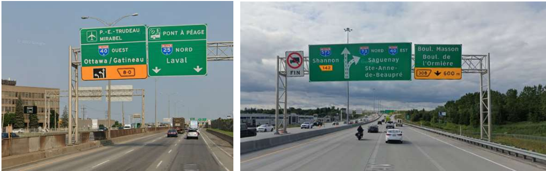
Fig. II-49. Preseñalización –sin indicar distancia– con señales de código, a la izquierda; a la derecha, cartel diagramático. De izquierda a derecha: A-25, salida 8-0, sentido norte; A-40, salida 142, sentido este. Google Street View
