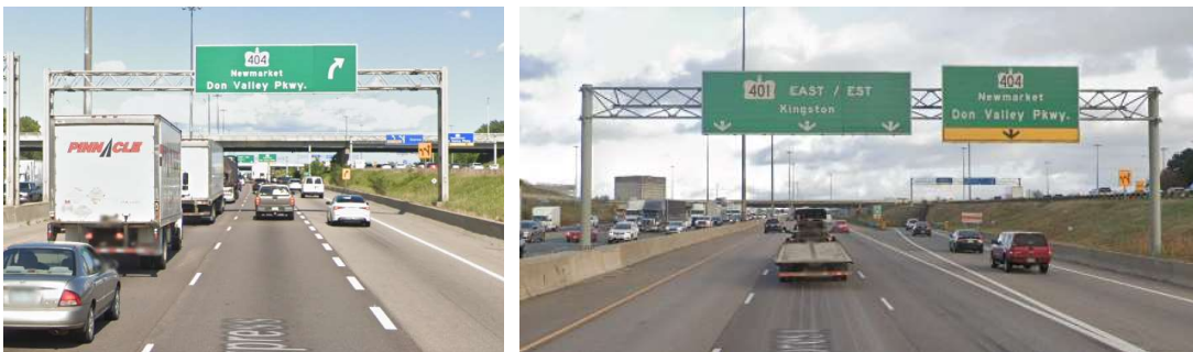
Fig. II-50. Preseñalización y señalización inmediata de salida con pérdida de carril y no bífida, empleando las overhead advance signs con flechas unicéfalas. Nótese la posición del destino de la salida a la izquierda de la flecha. Salida sin numerar de la Highway 401 sentido este, calzadas express , a la altura de la salida 375 de la colectora sentido este. Google Street View
