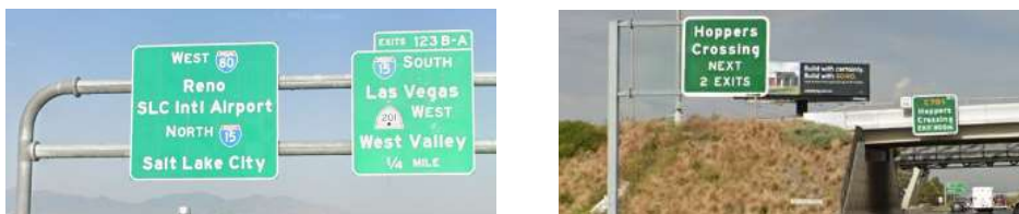
Fig. I-12. A la izquierda, señal de dirección propia sólo listando destinos y otra sólo indicando la distancia a la salida: «1/4 de milla»; a la derecha, pareja de señales indicando «siguientes dos salidas» y «salida 800 m». I-80 oeste, salida 124, Utah, Estados Unidos; M1 oeste, salida 16, Victoria, Australia. Google Street View
