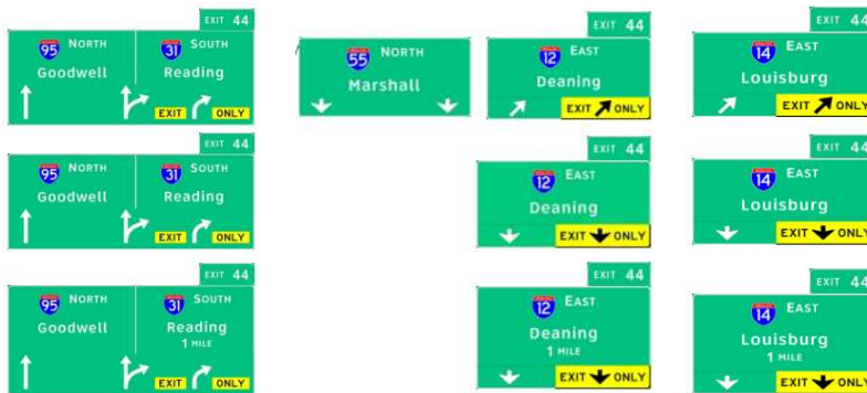
Fig. II-72. Carteles ensayados. De izquierda a derecha: flecha por carril, convencionales con dirección propia y sin dirección propia. Kay Fitzpatrick, Susan T. Chrysler, Marcus A. Brewer, Alicia Nelson y Vichika Iragavarapu
