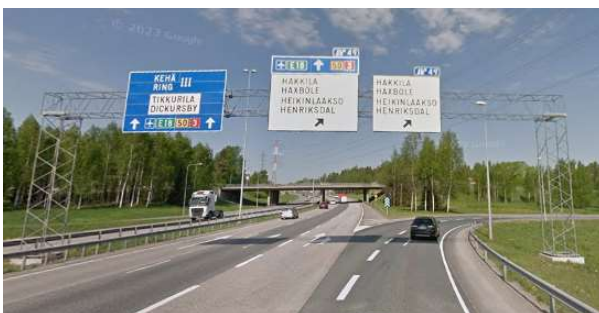
Fig. II-39. Apilamiento para señalar un carril bífido. Salida 49 de la E18, sentido oeste. Google Street View
