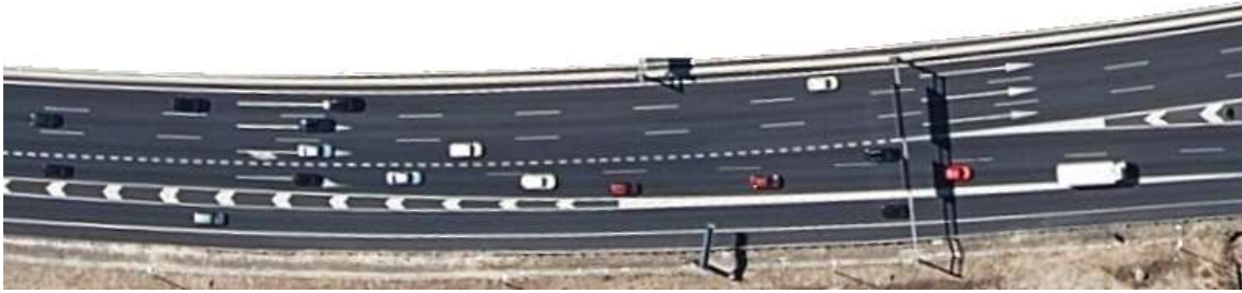
Fig. I-7. Salida 31 de la autopista M-40, sentido horario. Se ha recortado la otra calzada. Nótese cómo la salida se conforma por un carril de deceleración de tipo paralelo —delimitado con la marca vial M-6.6 (taqueado para carril especial)— pero también por uno de tipo directo —adosado por el interior, antes de la nariz de la bifurcación— al que necesariamente se ha de acceder desde el carril básico situado más a la derecha del tronco, circunstancia acertadamente señalizada con las flechas de la calzada. Instituto Geográfico Nacional, elaboración propia
