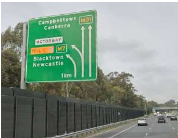
Fig. II-59. Lane allocation sign preseñalizando un carril bífido directo, sí indicando distancia. No es extraño en este estado que una salida no se señalice con pórticos en ningún punto, recurriéndose únicamente a carteles laterales. Bifurcación del final de la M5 sentido oeste en el nudo Roden Cutler. Google Street View
