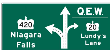
Fig. III-10. A la izquierda, cartel diagramático indicando una divergencia múltiple; ejemplo ofrecido en el Manual of Uniform Traffic Control Devices for Canada . A la derecha, cartel diagramático preseñalizando dos salidas sucesivas; I-70 sentido este, salidas 418B y A, Texas, Estados Unidos. Transportation Association of Canada; Google Street View .
