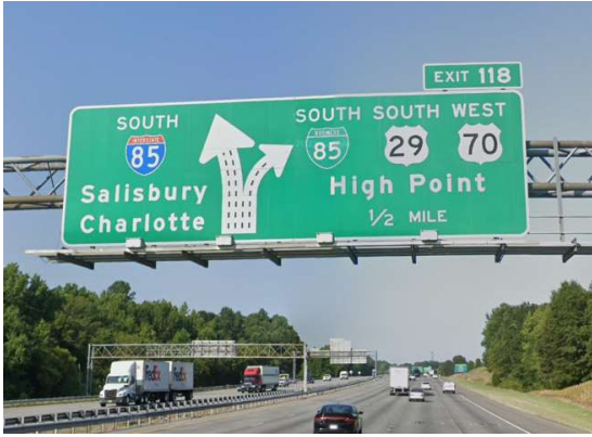
Fig. I-19. Cartel diagramático, ampliación en su flecha. I-85 sur, salida 118, Estados Unidos. Nótese la diferencia de grosores acorde al número de carriles. Google Street View
