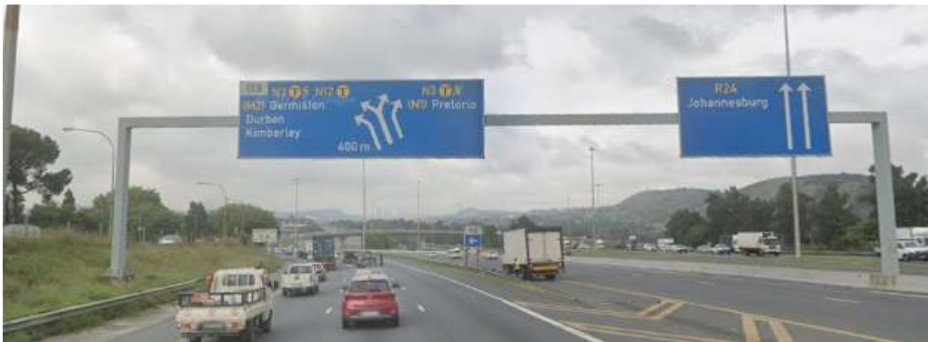
Fig. II-64. Señalización de salida inmediata. Nótese la inclinación del grupo de flechas en el cartel izquierdo para recalcar su posición dentro del ramal o el descentrado a la derecha de las del cartel de dirección propia. Salida 113 de la R24, sentido oeste, Sudáfrica. Google Street View
