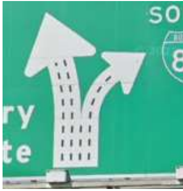
Fig. I-19. Cartel diagramático, ampliación en su flecha. I-85 sur, salida 118, Estados Unidos. Nótese la diferencia de grosores acorde al número de carriles. Google Street View
