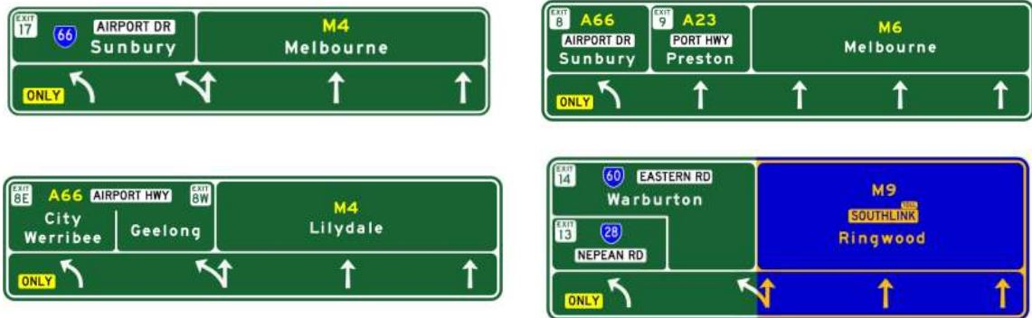
Fig. II-60. Algunos ejemplos ofrecidos en el Supplement para las señales GE1-V14, empleando carteles flecha por carril y cajas . VicRoads
