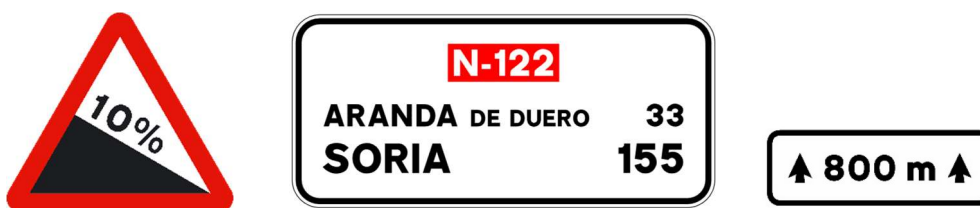
Fig. I-2. Ejemplos de la clasificación de la norma 8.1-IC (no a escala). A la izquierda, señal de contenido fijo (P-16a); en el centro, cartel (S-600); a la derecha, panel complementario (S-810). Ministerio del Interior; elaboración propia
