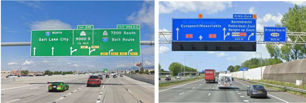
Fig. III-11. A la izquierda, cartel flecha por carril donde, con dos flechas bífidas, se indican sucesivas divergencias con carril bífido; I-15 sentido norte, salida 294 A-C, Utah, Estados Unidos. A la derecha, cartel basado en texto acompañando en el pórtico a otro flecha por carril, para indicar una salida próxima que se encuentra en la pata derecha de la divergencia. A15 sentido norte, salida 9, Países Bajos. Google Street View, Google Street View
