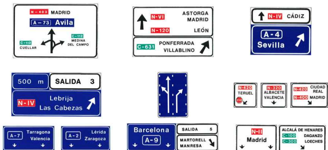
Fig. II-3. Algunas de las señales de mayor interés de las mostradas en el Catálogo de señales de circulación de 1986 [54]. 7 Nótese la presencia de la S-210, croquis, arriba a la izquierda; o la S-260 en el centro. Ministerio de Obras Públicas y Urbanismo
