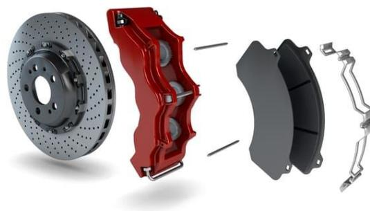
Figura 2: Pinza y pastillas de freno
