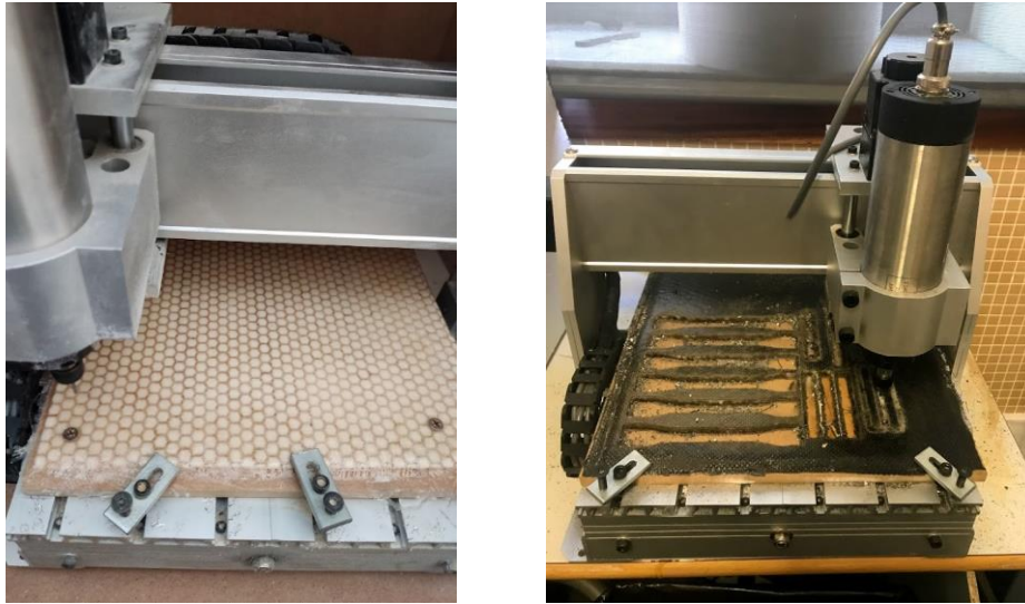
ILUSTRACIÓN 73: IZQ. SUJECCIÓN DEL LAMINADO CON GRAPAS. DER. CORTE DE PROBETAS
