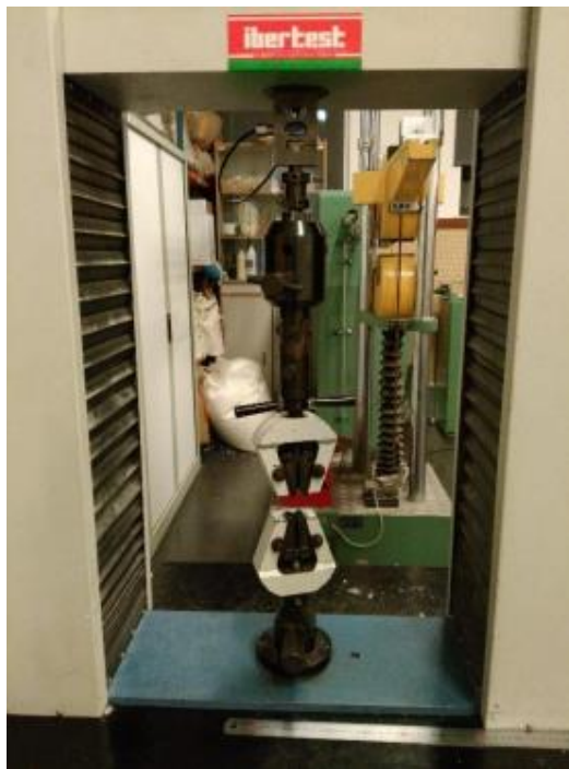
ILUSTRACIÓN 77. IZQ. MUE IBERTEST ELIB-50W, DER. DIAGRAMA ENSAYO DE TRACCIÓN.
