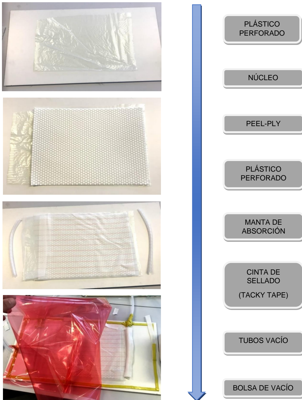
ILUSTRACIÓN 60: COLOCACIÓN DE LA PRIMERA CAPA - PLÁSTICO PERFORADO
