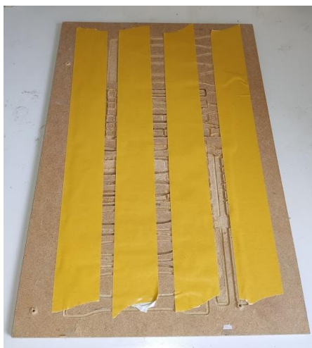
ILUSTRACIÓN 72: MÉTODO DE FIJACIÓN DEL LAMINADO CON CINTA DE DOBLE CARA Y TORNILLOS
