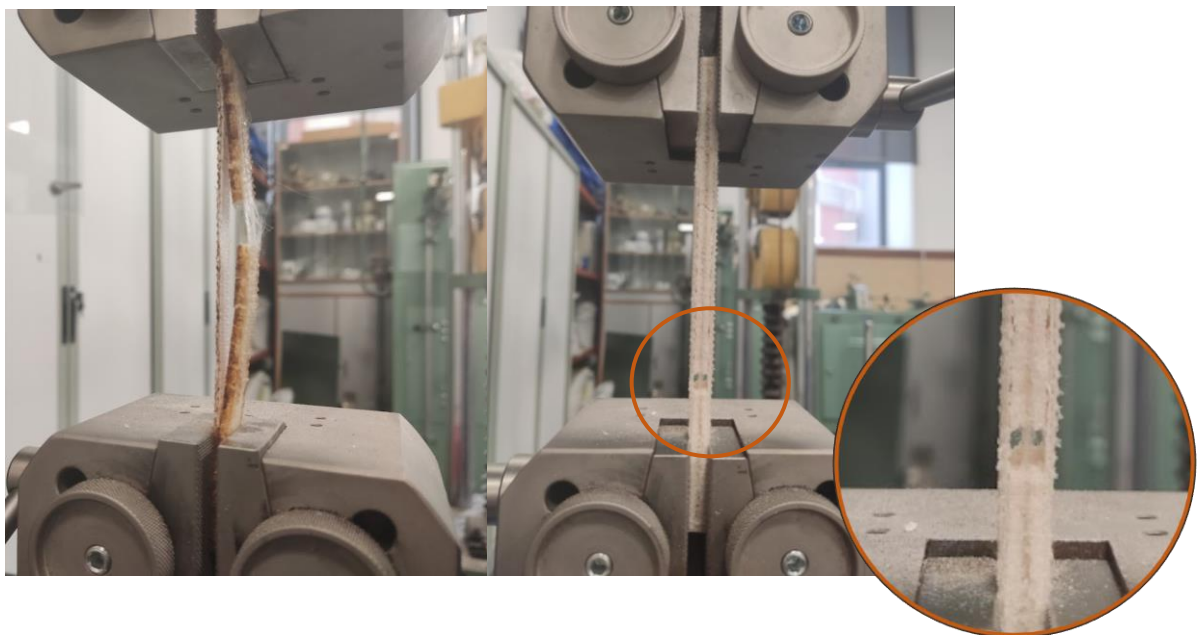
ILUSTRACIÓN 82. ROTURA DE PROBETA EN ENSAYO DE TRACCIÓN DEL COMPOSITE DE POLIPROPILENO.
