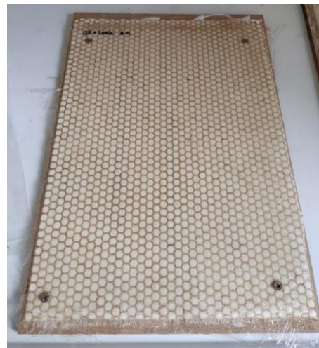
ILUSTRACIÓN 72: MÉTODO DE FIJACIÓN DEL LAMINADO CON CINTA DE DOBLE CARA Y TORNILLOS
