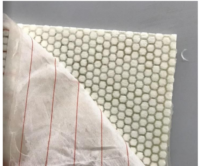
ILUSTRACIÓN 69: PROCESO DE DESMOLDEADO Y RETIRADA DEL PEEL PLY
