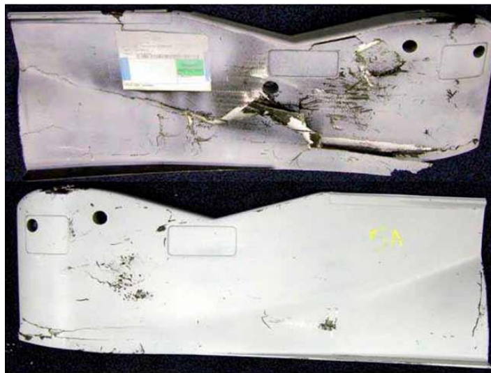
ILUSTRACIÓN 21. COMPARACIÓN DE PIEZA CARBONO - ARAMIDA (ARRIBA) Y CARBONO - POLIPROPILENO (ABAJO) - WWW.INTEREMPRESAS.NET/AERONAUTICA .
