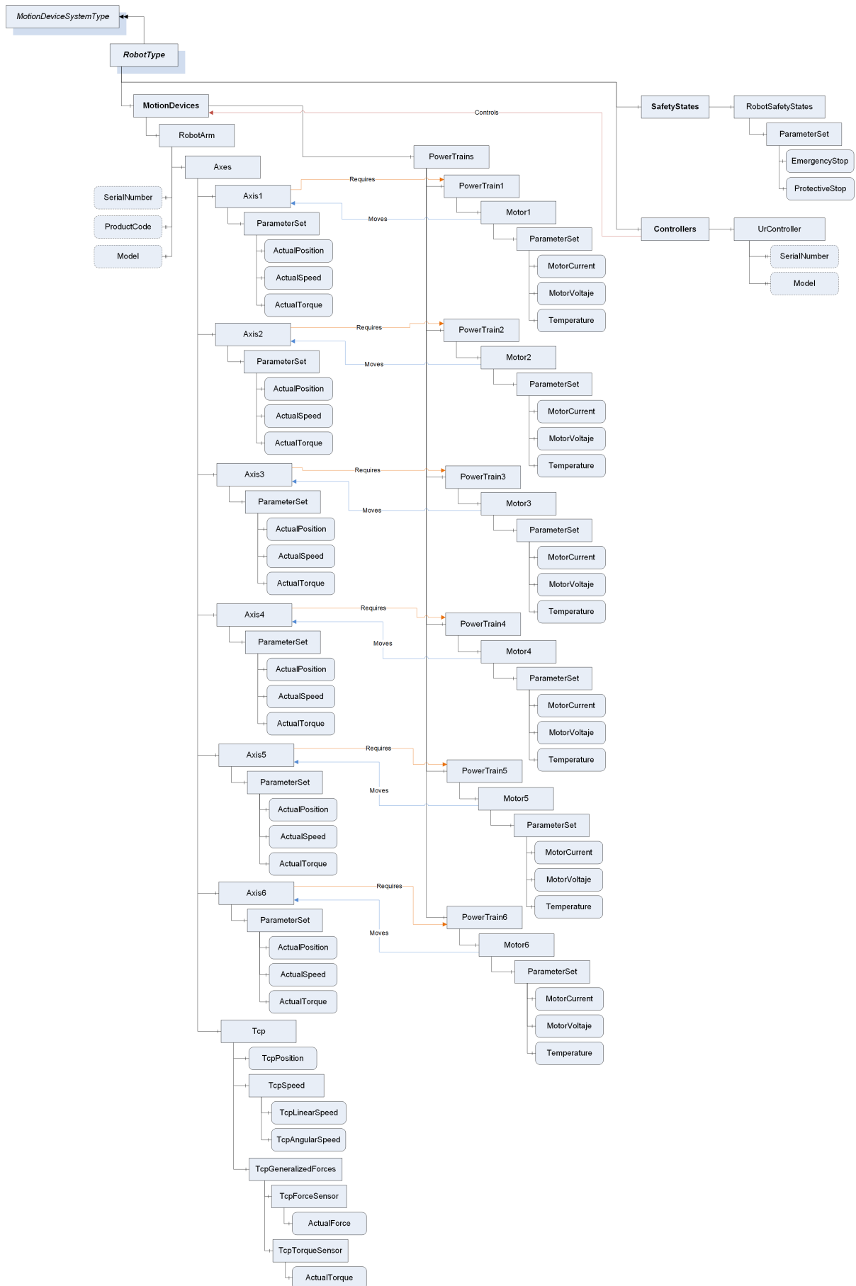
Figura A.3: Diagrama de bloques OPC UA estandarizado del modelo de información personalizado del gemelo digital.
