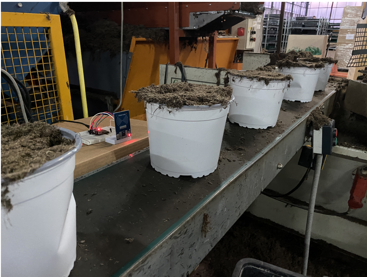
Figura 5.2: Lector RFID en la cinta transportadora Fuente: Propia
